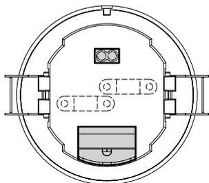
**!** Bei Verwendung der mitgelieferten hinteren Abdeckung des Sensors ist auf die korrekte Montage zu achten. Sie muss so montiert werden, dass sich der Kabelausschnitt auf der gegenüberliegenden Seite der Anschlussklemme befindet.
