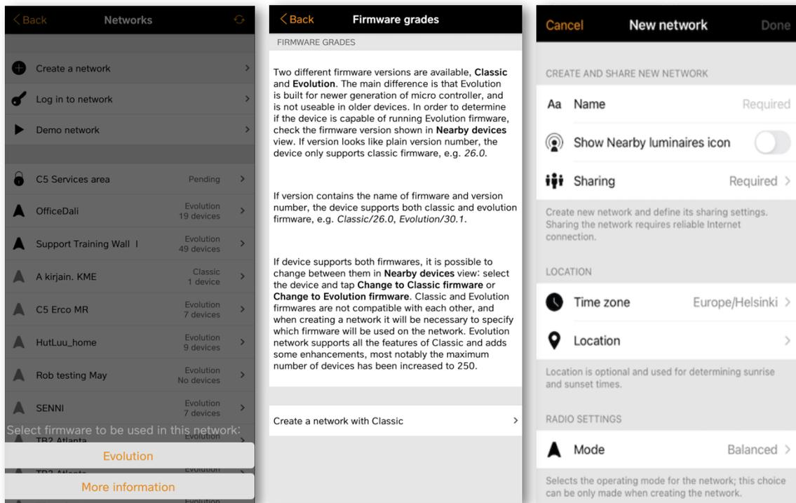
Unter den Funk-Einstellungen für das Netzwerk kann zwischen drei verschiedenen Modi ausgewählt werden. Der jeweilige Modus bestimmt die Kommunikationsgeschwindigkeit und den möglichen Kommunikationsbereich für Geräte im Netzwerk.
