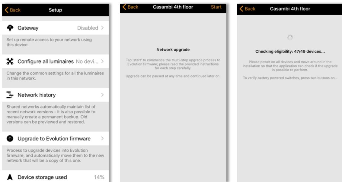
Wenn alle Geräte kompatibel sind, wird die Firmware der einzelnen Geräte aktualisiert. Dieser Vorgang kann einige Zeit dauern, abhängig davon wie viele Geräte Sie in Ihrem Netzwerk haben. Dabei kann möglicherweise die Meldung *Warten auf Gerät 1/x* angezeigt werden.
