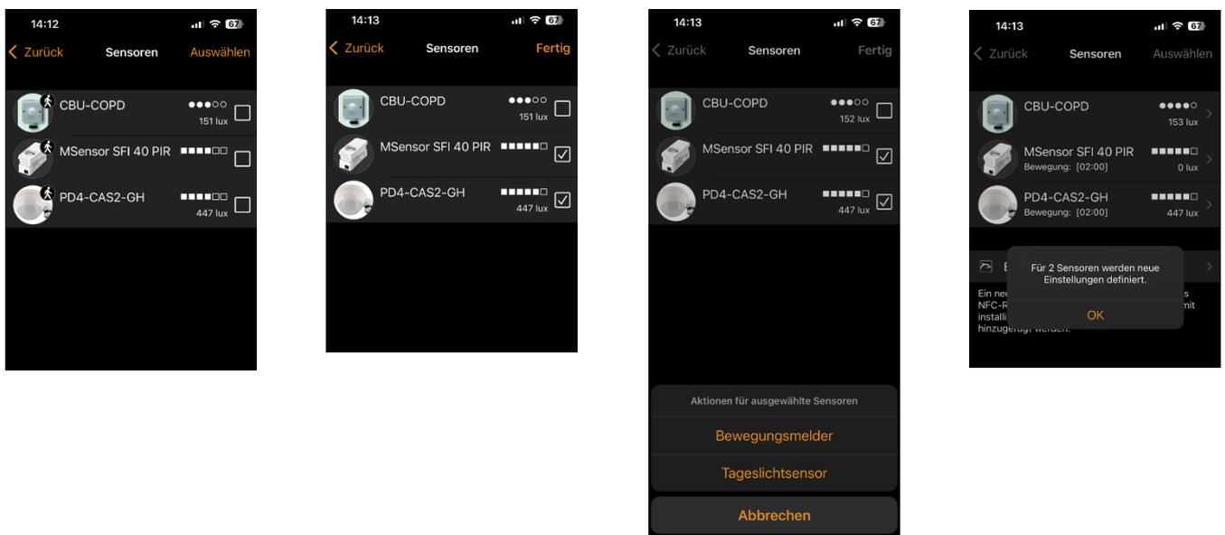
Hinweis: Starten Sie das Netzwerk immer neu (Mehr, Netzwerkeinrichtung, Alle Leuchten konfigurieren, Netzwerk neu starten), wenn Sie Änderungen an einer Szene vornehmen, nachdem diese bereits einem Sensor zugewiesen wurde. Dadurch wird sichergestellt, dass der Sensor die neue Szenenkonfiguration erhält.
