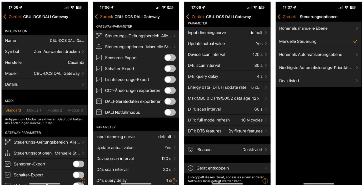
Die Eingangsdimmkurve (Input dimming curve) definiert, wie die Dimmwerte, die das DALI-System an das Casambi DALI-Gateway sendet, interpretiert und innerhalb des Casambi-Netzwerks weitergesendet werden.
